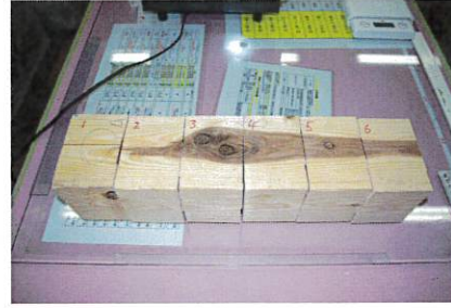
※芯部密度の高い③と柱中央部の⑥を全乾法の対象とする。
