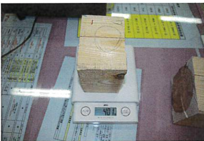
※試験片6点の、オープン投入前の含水率を測定した。
