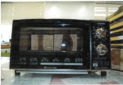
※試験片③と⑥を8時間全乾させる
