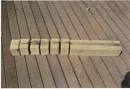
※80mm幅で6つ試験片を切り出した。
