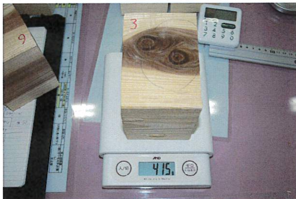
※全乾法にて最終的に10時間経過時の試験片の重量
